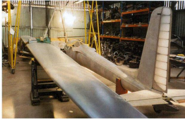
Fig. 5.8 – Recouvrement Diatex sur le fuselage
